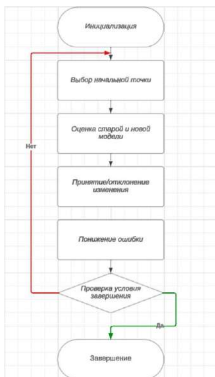
Рис. 4. Блок-схема SA-алгоритма для оптимизации гиперпараметров Составлено авторами
